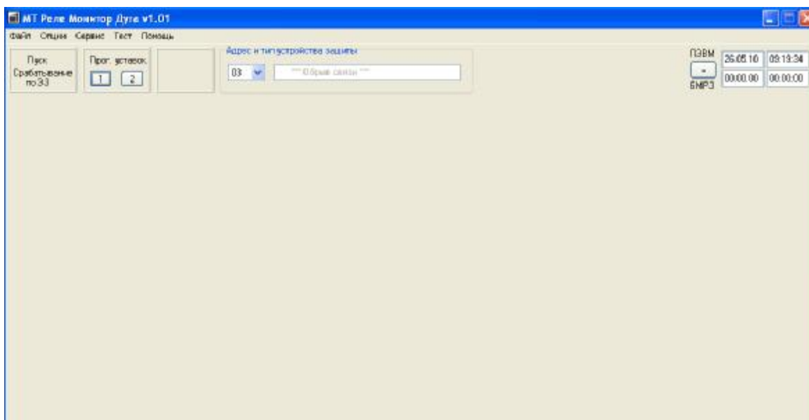
Рисунок В.1 - Главное окно программы "МТ Реле Монитор Дуга" в случае неправильной настройки связи блока с ПЭВМ
