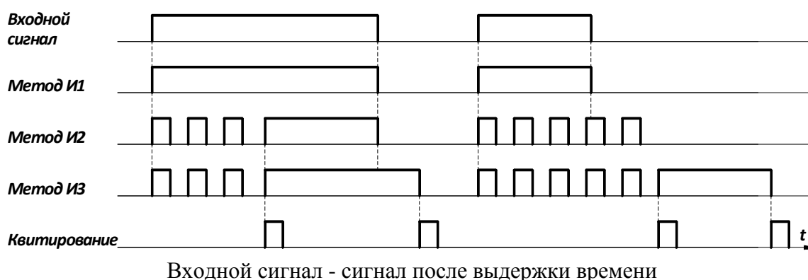
Рисунок 4 - Временные диаграммы управления индикацией
