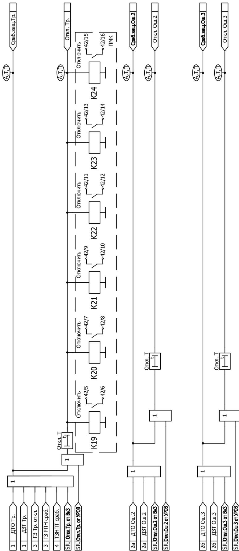
Рисунок Б.7 - Функциональная схема алгоритма формирования сигналов отключения
