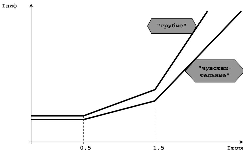
Рисунок 6 - Характеристики срабатывания "грубой" и "чувствительной" ДЗТ
