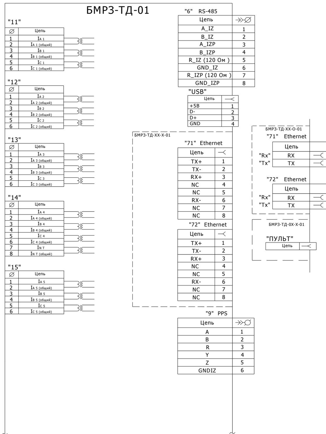
Рисунок А.1 (лист 1 из 2) - Схема электрическая подключения
