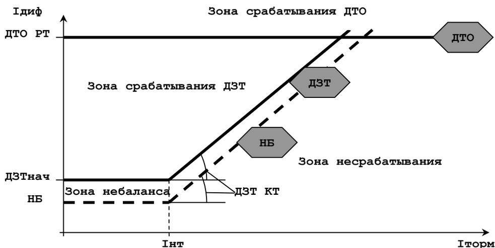
Рисунок 7 - Характеристика срабатывания дифференциальных защит ошиновки
