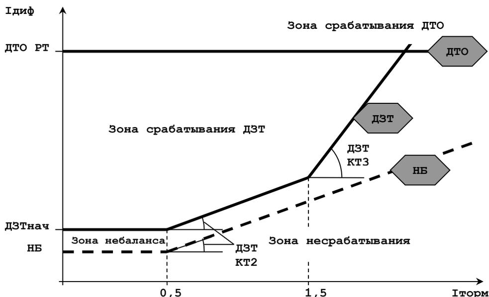
Рисунок 5 - Характеристика срабатывания дифференциальных защит Т (АТ)
