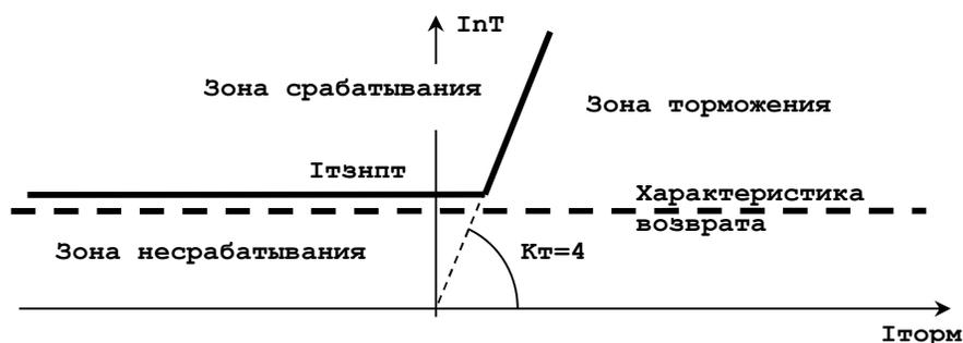
Рисунок 8 - Характеристика срабатывания и возврата ТЗНПТ
