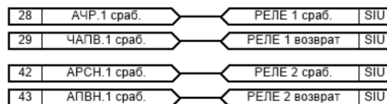
Рисунок 2 – Пример подключения бистабильных реле
