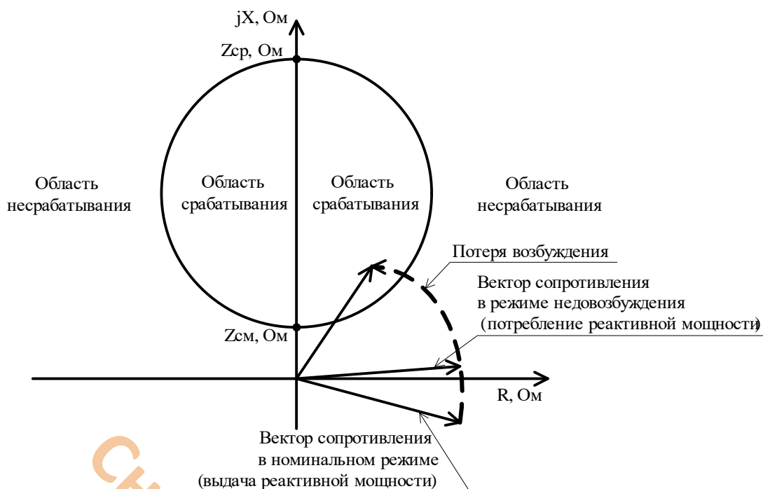
Рисунок 6 - Характеристика защиты от асинхронных режимов
