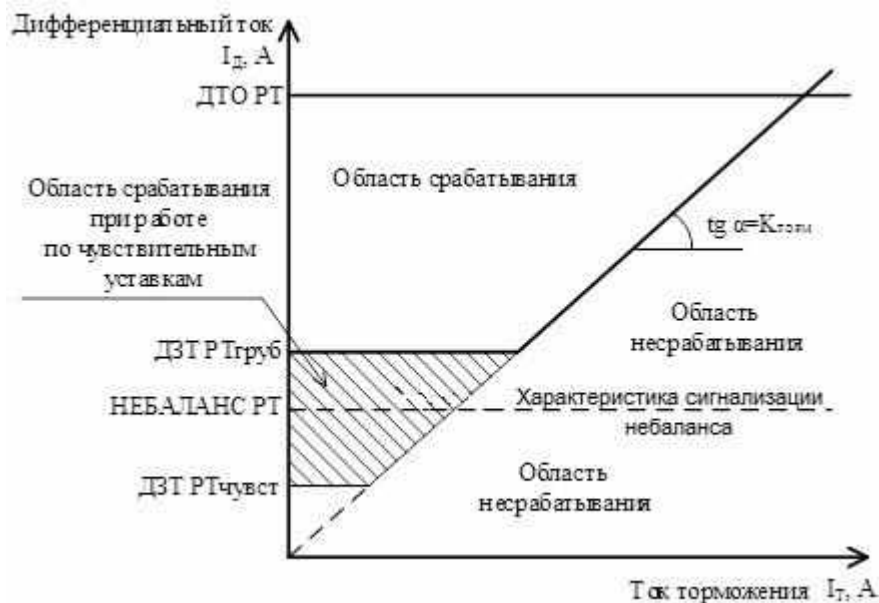
Рисунок 5 - Характеристика срабатывания дифференциальных защит
