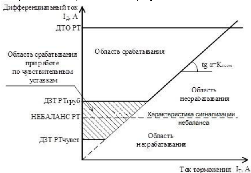
Рисунок 5 - Характеристика срабатывания дифференциальных защит
