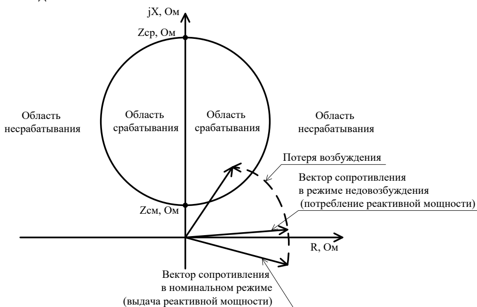
Рисунок 10 - Характеристика защиты от асинхронных режимов
