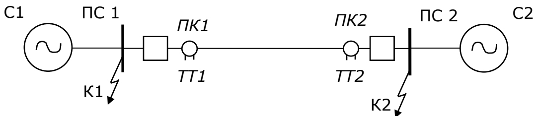
Рисунок 10.1 – Линия с двусторонним питанием
