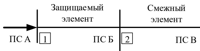
Рисунок 1 - Расчетная схема для выбора уставок релейной защиты
